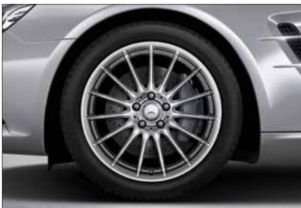
Легкосплавный многоспицевый диск, лакировка «Серебристый ванадий», шины 255/40 R 18 спереди и 285/35 R 18 сзади (серийно для SL 500, код R34).
