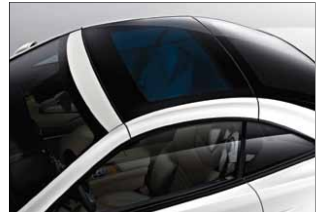
Панорамная крыша «Варио» с системой MAGIC SKY CONTROL.
