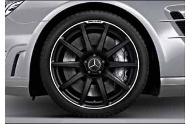
Кованый диск AMG с 10 спицами, матово-черный, с полированным ободом, шины 255/35 R 19 впереди и 285/30 R 20 сзади (опция, только для моделей Mercedes-AMG, код 767).
