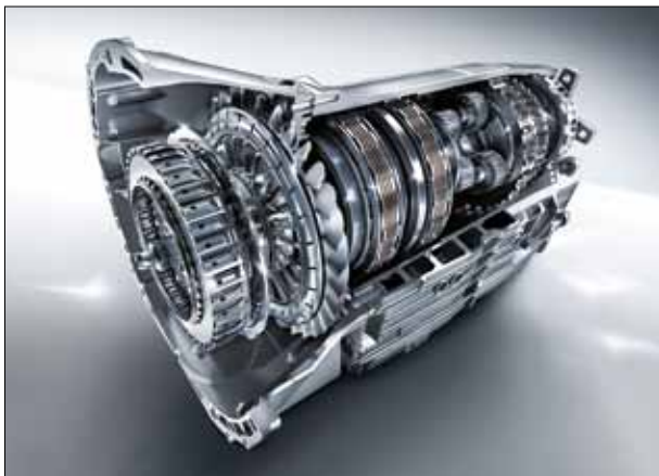
Впервые в 12-цилиндровой модели «Мерседес-Бенц»: 7-ступенчатая АКП AMG SPEEDSHIFT PLUS 7G-TRONIC.
