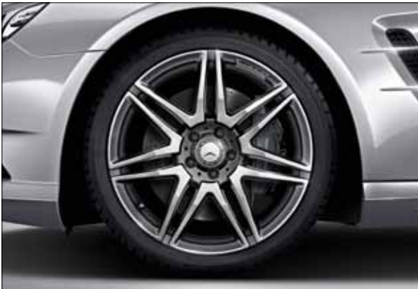
Легкосплавный диск AMG с 7 двойными спицами, лакировка «Серый титан», полированный, шины 255/35 R 19 спереди и 285/30 R 19 сзади (опция, компонент AMG Line, код 785).
