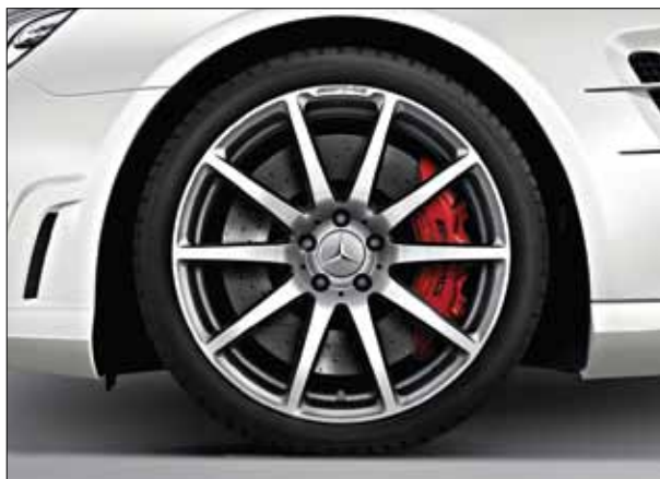
Кованые диски AMG с 10 спицами с красными тормозными суппортами.
