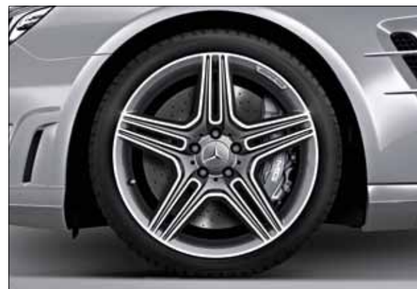
Легкосплавный диск AMG с 5 сдвоенными спицами, лакировка «Серый титан», полированный, шины 255/35 R 19 впереди и 285/30 R 19 сзади (серийно для Mercedes-AMG SL 63, код 793).
