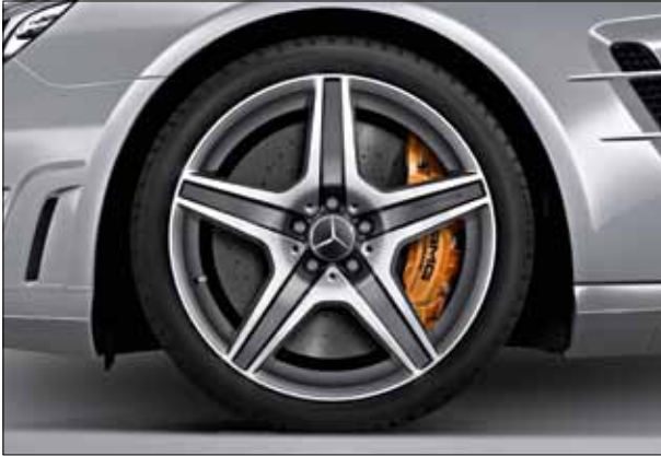
Легкосплавный диск AMG с 5 спицами, лакировка «Серый титан», полированный, шины 255/35 R 19 впереди и 285/30 R 19 сзади (серийно для Mercedes-AMG SL 65, код 797).
