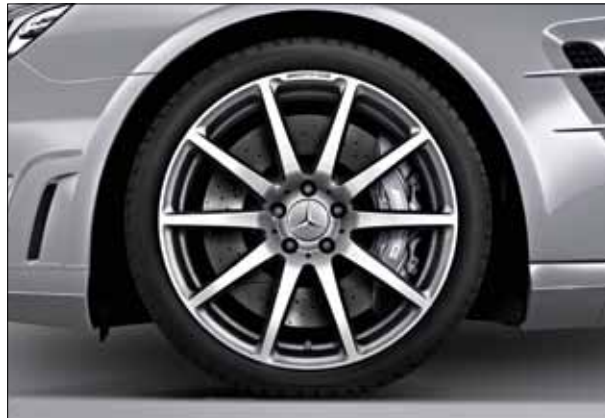
Кованый диск AMG с 10 спицами, лакировка «Серый титан», полированный, шины 255/35 R 19 впереди и 285/30 R 20 сзади (опция, только для моделей Mercedes-AMG, код 766).
